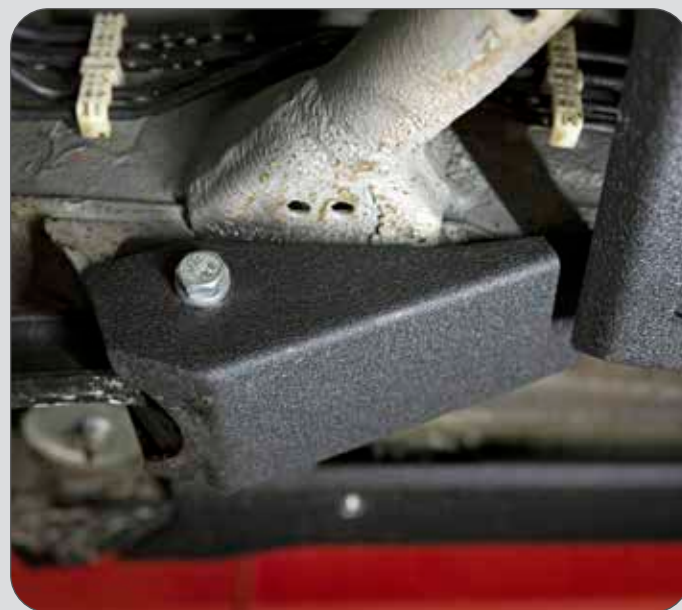
Unterfahrschutz Suzuki® Jimny GJ Aufnahme Längslenker
