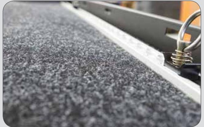
Mühelos lassen sich auch verschiedene Airlineschienen und andere Zurrpunkte montieren. Es sind 2 Airlineschienen mit 4 verstellbaren Beschlägen seitlich verbaut.
