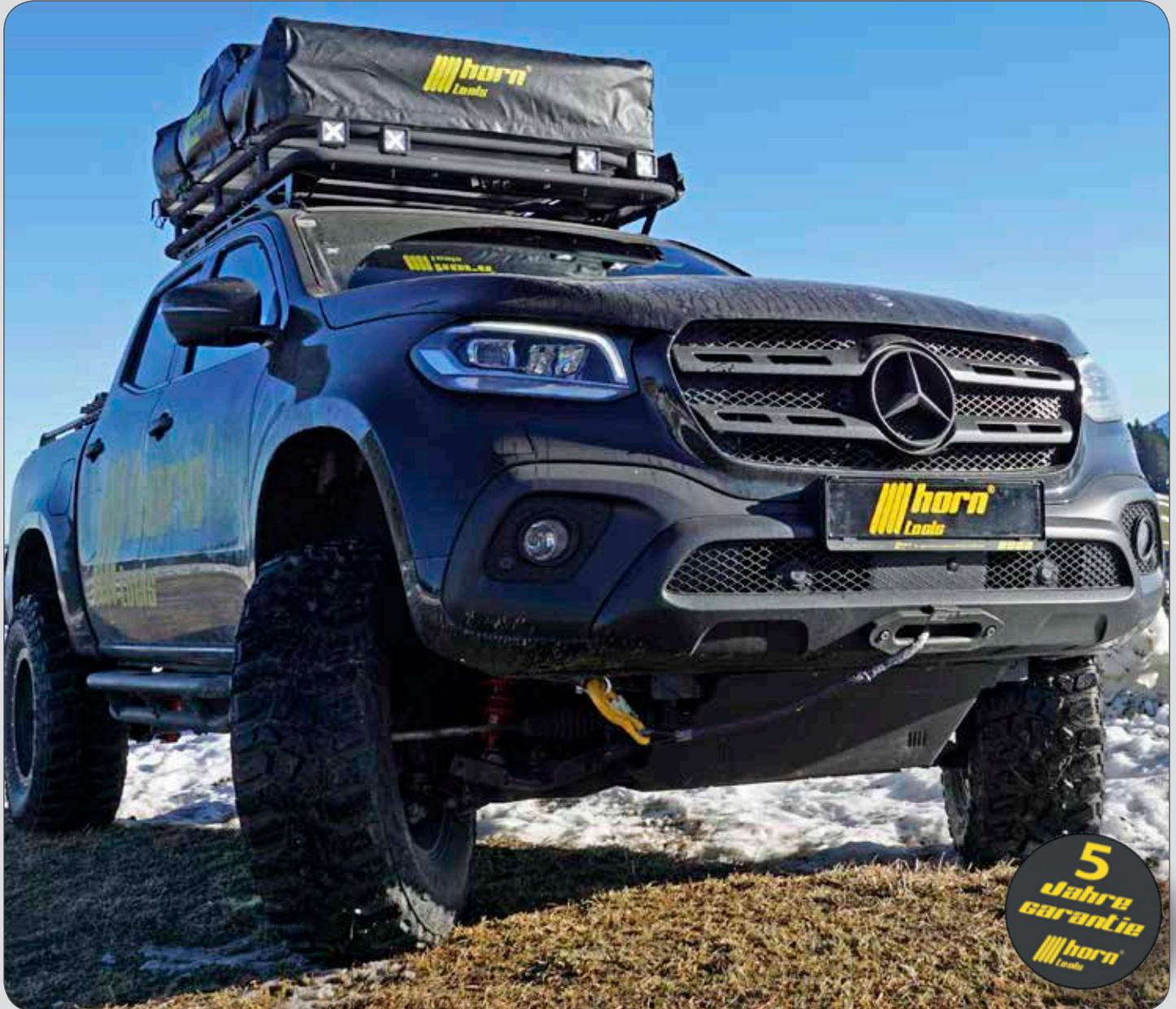
Die starke 4,3 Tonnen Seilwinde wurde speziell für die X-Klasse entwickelt. In erster Linie ist die Seilwinde zur Selbstbergung gedacht. Natürlich kann die Super Speed Seilwinde auch benutzt werden, um andere Fahrzeuge zu bergen oder Baumstämme heranzuziehen.
