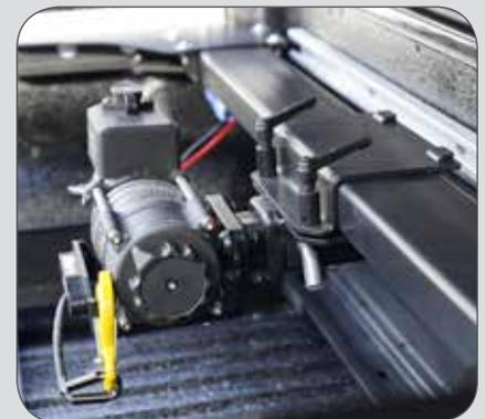
Das Seilwindensystem wurde extra für die X-Klasse entwickelt. Der Träger wird direkt in das Schienensystem von Mercedes eingebunden. Die Heckseilwinden eignen sich hervorragend um Wild zu bergen oder um andere Lasten auf die Ladefläche zu ziehen. Alle Modelle verfügen über eine Funkfernbedienung. Das Top Modell mit 80m Seil kann mit einer Geschwindigkeit von 15m/min einrollen. Die Windensysteme sind für Gewichte bis 300kg ausgelegt. Die Seilwinde ist stufenlos von links nach rechts verschiebbar.
