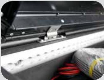
Die Abdeckung ist in einer Minute ohne Werkzeug abgebaut. Das robuste Scharnier kann ganz einfach ausgehängt werden.
