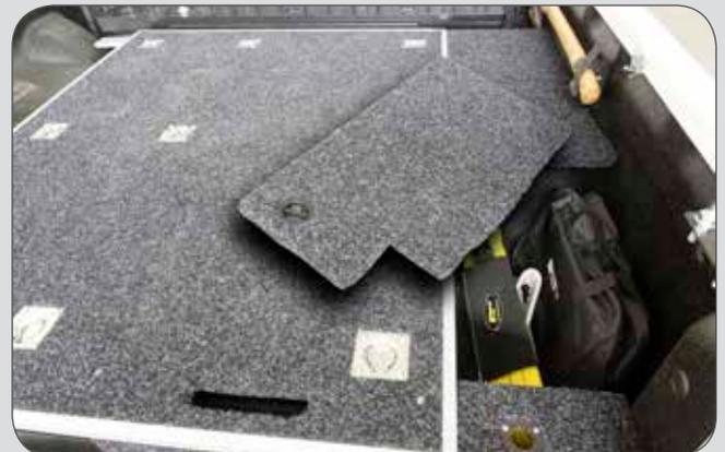
Die Seitenverkleidungen dienen gleichzeitig als großzügige Staufächer. Die Seitenteile sind universell einsetzbar und können individuell zugeschnitten werden (Art-Nr. PHCDSW). Gummistopfen dämpfen Erschütterungen und reduzieren klappernde Geräusche.
