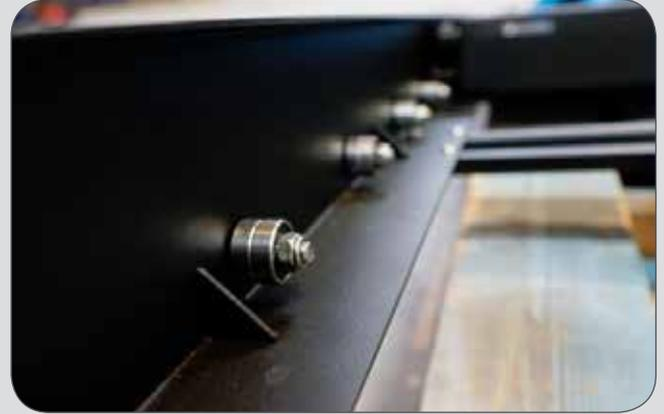
Die über 50 Lager pro Auszug sorgen für ein gleichmäßiges und leichtes Bedienen auch bei Schwerlast.
