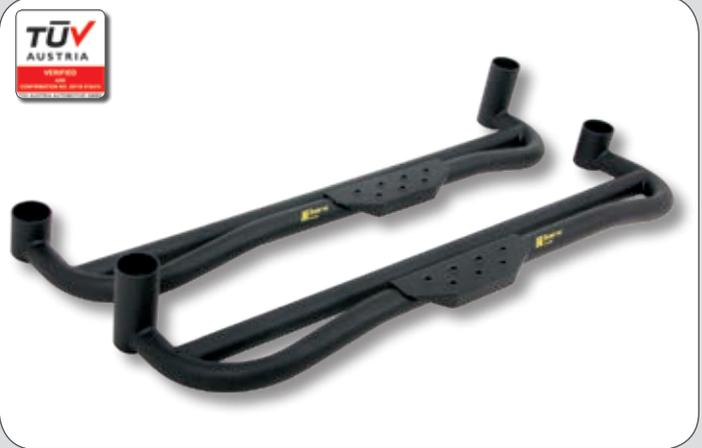
Der robuste Seitenschweller schützt deinen Jimny im Gelände. Die Tritte wurden abgekantet, damit man nirgends hängen bleibt. Montiert werden die Side Steps auf den originalen Befestigungspunkten. Inklusive TÜV Teilegutachten.
