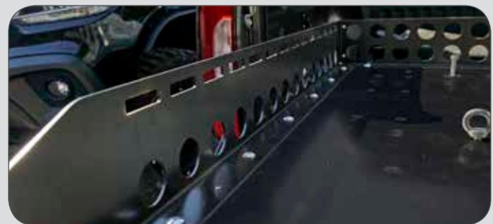
Die abnehmbaren Seitenteile verfügen über Zurrmittel Aufnahmen für große Ratschen Gurte und Haken, um die Ladung zu sichern. Die Seitenwände sind um 30mm nach außen verstellbar, somit kann die komplette Breite vom Ladebett genutzt werden.
