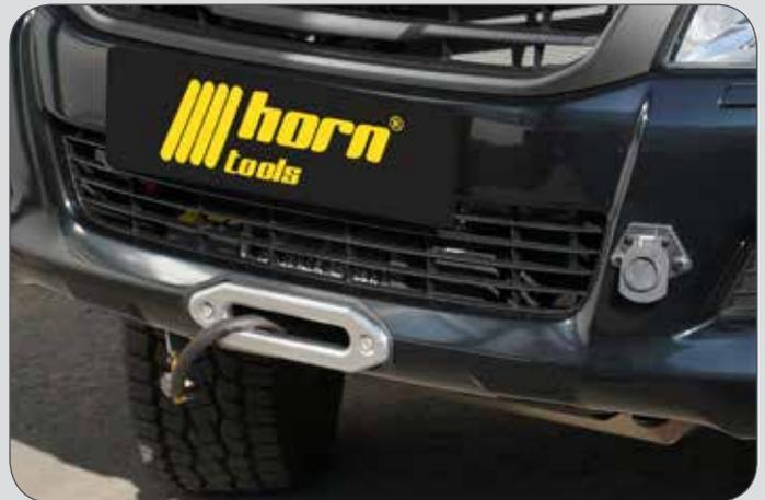
Die perfekt ins Fahrzeug integrierte Seilwinde wertet das Erscheinungsbild massiv auf. Die Seilwinden Konstruktion verteilt die 4,3t Zugkraft gleichmäßig auf den Rahmen und verstärkt zusätzlich noch den Frontaufbau. Für die Eintragung beim TÜV liegt wie bei allen Systemen das Gutachten bei. Kompakt in das Fahrzeug integriert präsentiert sich das Einbausystem für den Hilux. Zum Anbau werden ausnahmslos originale Haltepunkte verwendet.
