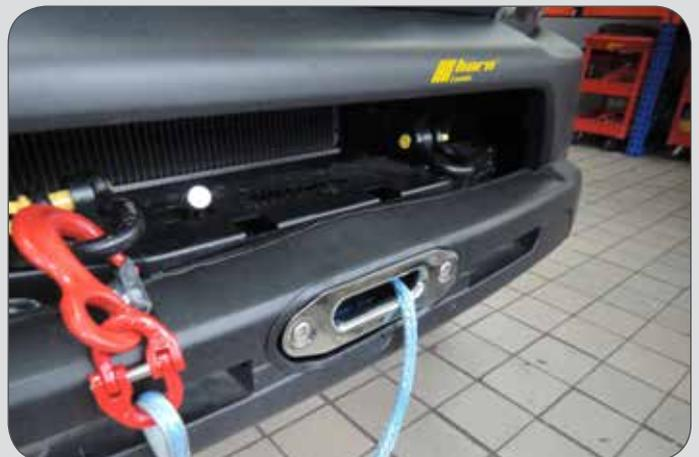
Das voll integrierte Seilwindensystem für den Jimny gibt es in 2 Ausführungen. Inklusiv einer Funkfernbedienung und einem 30m Seil mit 8mm Stärke. Das System ist inklusive TÜV Teilegutachten.
