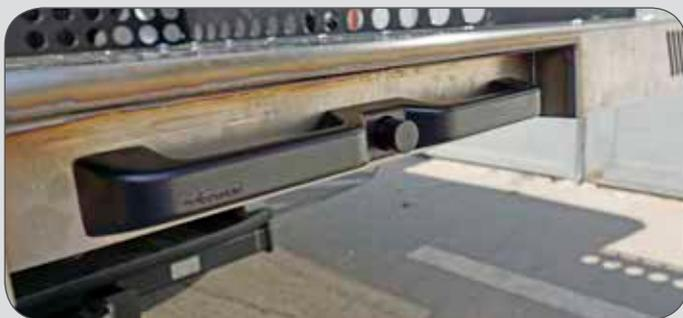
Der Accuride Hochleistungsverschluss ermöglicht eine Zwei-Hand Bedienung. Diese Griffsysteme werden hauptsächlich im Feuerwehr und Kommunalbereich eingesetzt. Wenn der Griff losgelassen wird rastet der Auszug ein, alle 17cm - aktiver Unfallschutz! Die hoch belastbaren Qualitäts-Stahl-Bolzen kombiniert mit den Gummipuffer Endanschlägen vorne und hinten machen das Handling auch mit 600kg Ladung kinderleicht.
