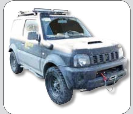
Unser Leichtgewicht, die Beta 5.0, zählt mit einer Zugkraft von 2,2to zu den effizientesten Bergewinden. Ideal für Fahrzeuge wie Jimny's oder große UTV's, da sich der Durst der Winde mit maximal 230 Ampere in Grenzen hält.
