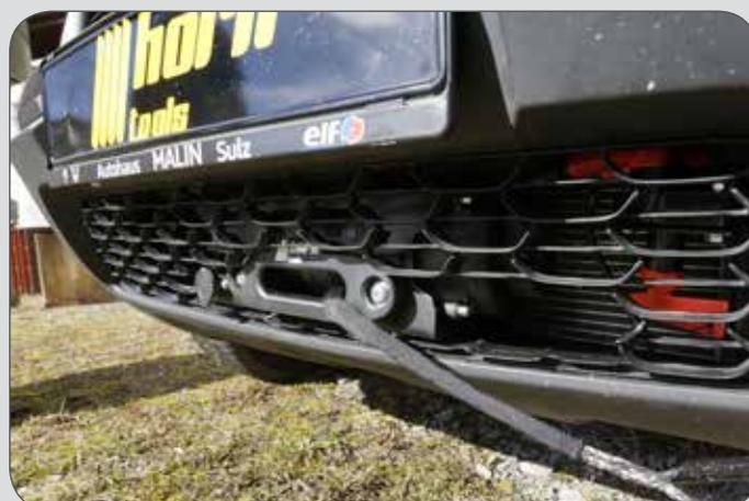
Ein voll integriertes Seilwindensystem für eines der erfolgreichsten Klein-Offroaders. Wir haben dem Duster eine 2to starke Winde spendiert und mit einem 6mm starkem 25m Kunststoff Seil bestückt.
