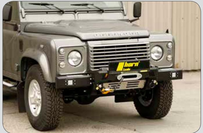
Eine Ära geht zu Ende, aus diesem Anlass haben wir eine völlig neue Stoßstange für die Legende gebaut. Beide Ecken sind schraubbar. Natürlich ist die Stoßstange verzinkt und pulverbeschichtet. Die Schäkel Halter aus Edelstahl runden das Design ab.
