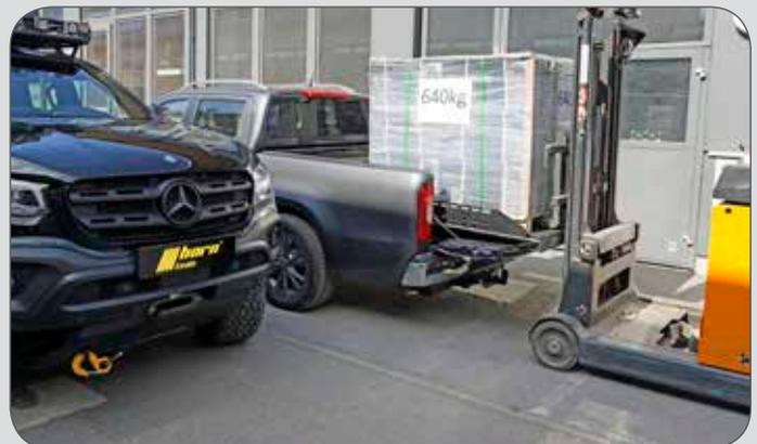
Das System ist für die Beladung mit dem Stapler ausgelegt. Da die volle Kapazität im ausgezogenen Zustand beladen werden darf, wird die Ladeklappe geschützt.
