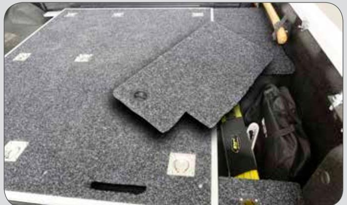
Die Seitenverkleidungen dienen gleichzeitig als großzügige Stauffächer. Die Seitenteile sind universell einsetzbar und können individuell zugeschnitten werden (Art-Nr. PHCDSW). Gummistopfen dämpfen Erschütterungen und reduzieren klappernde Geräusche.
