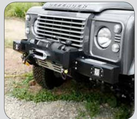
Die horn Alpha ist die stärkste und schnellste Winde in ihrem Segment. Erhältlich von 4,3 - 5,4to Zugkraft in verschiedenen Konfigurationen. Die perfekte Bergwinde für Fahrzeuge bis 3,5to.
