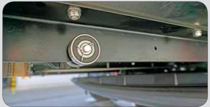
Der Rahmen läuft komplett auf 22 Kugellagern, die bei Bedarf sehr leicht gewechselt werden können.
