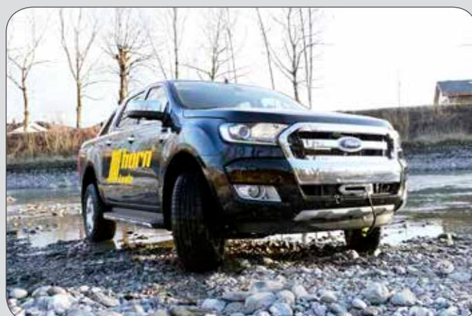
Die Ranger Seilwinden Konstruktion enthält einen massiven Unterfahrerschutz. Bei diesem System wird die 4,3to Seilwinde kopfüber montiert. Das 30m lange Kunststoffseil hat eine Bruchkraft von 7to. Bei Bedarf können andere Seile verwendet werden.
