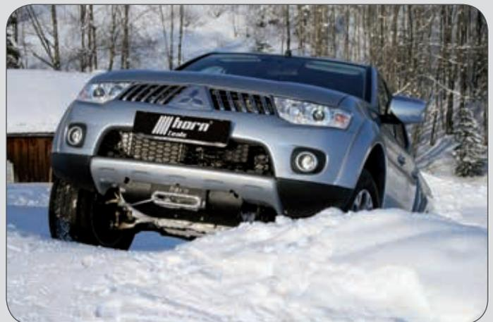
Für die Baujahre 2006 bis 2015 passt das spezielle 4,3to Seilwindensystem für den Mitsubishi. Die Seilwinde ist in eine Konstruktion eingebettet, die gleichzeitig eine Seilwindenplatte und ein Unterfahrerschutz ist. Durch die Position der Winde entlastet man die Achsen beim Ziehen. Der Böschungswinkel und die Bodenfreiheit bleiben gleich. Die Seilwinde zieht mit einer Geschwindigkeit von 15m/min.
