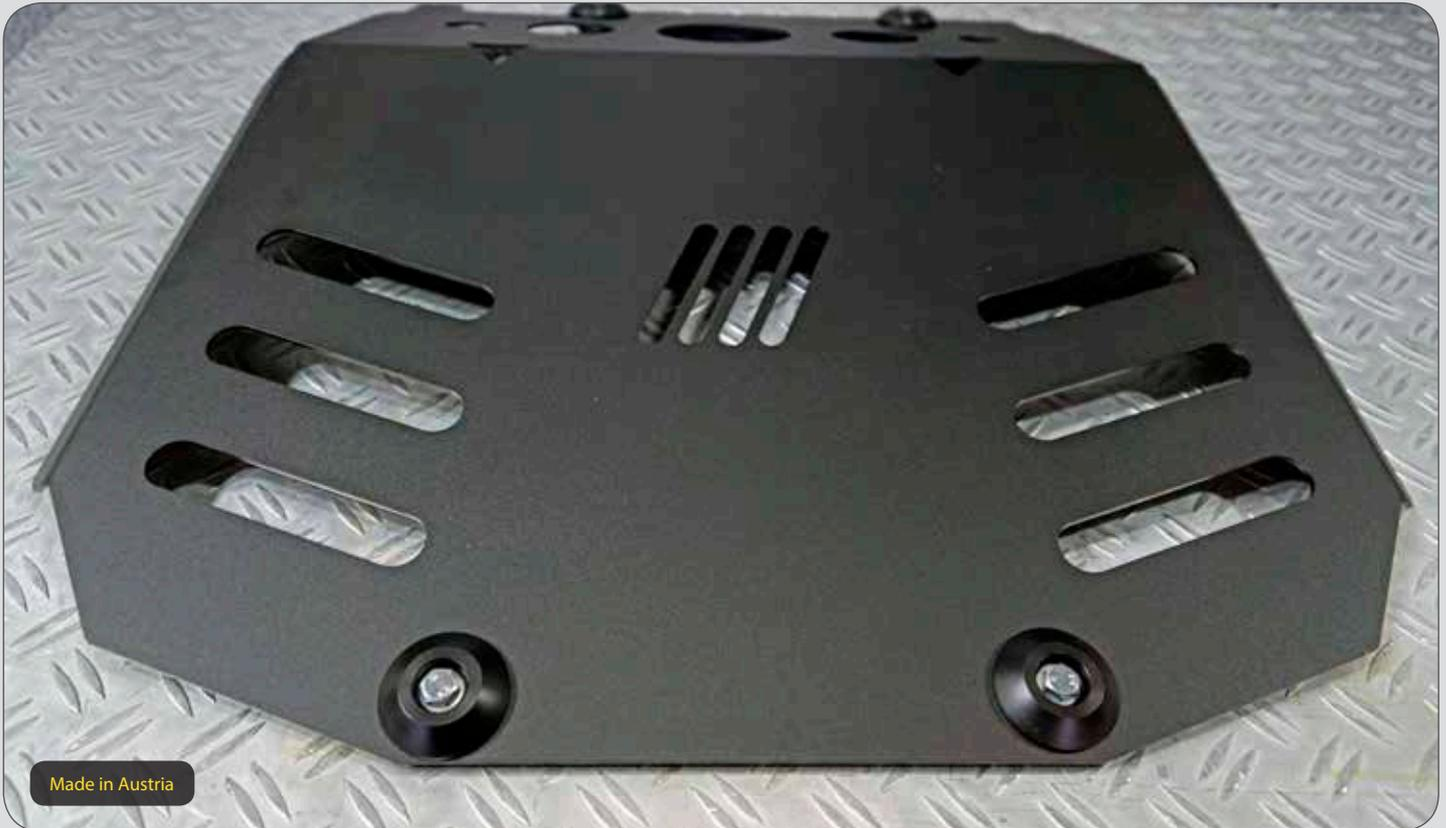
Der Screw Slider ist ein aus POM\* gedrehtes Teil, das ein Abscheren von Schraubenköpfen an exponierten Stellen verhindert, wie z. B. beim Unterfahrschutz. Der Werkstoff POM ist dauergeschmiert und gleitet immer mühelos über den Untergrund, wenn dein Fahrzeug aufsetzt.
