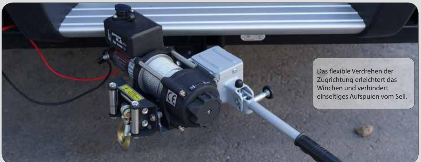
Das flexible Verdrehen der Zugrichtung erleichtert das Winchen und verhindert einseitiges Aufspulen vom Seil.
