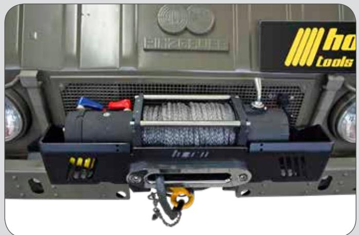
Das Pinzgauer System ist fix verschraubt über die gesamte Länge der Frontstoßstange auf den originalen Punkten. Das gewährleistet eine gleichmäßige Verteilung der Kräfte auf das Fahrzeug. Das System ist in Leichtbauweise gefertigt, da der Pinzgauer vorne schon original kopflastig ist. Der Böschungswinkel wird durch die Seilwinde nicht beeinträchtigt. Die Anbauteile sind verzinkt und gepulvert.
