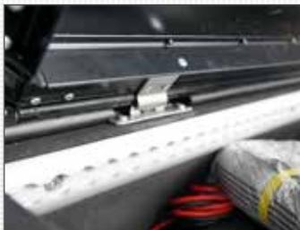
Sollte das trotzdem einmal der Fall sein, ist die Laderaum Abdeckung in Minuten ohne Werkzeug abgebaut. Das robuste Scharnier kann ganz einfach ausgehängt werden.
