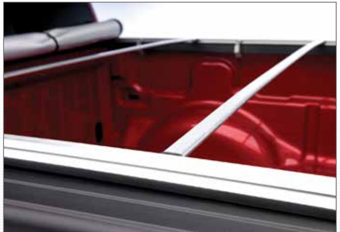
Die Quertraversen verhindern das Flattern auf der Autobahn und sorgen dafür, dass das Regenwasser abläuft. Sie sind mit einem Handgriff verstellbar oder ausgeklippt.
