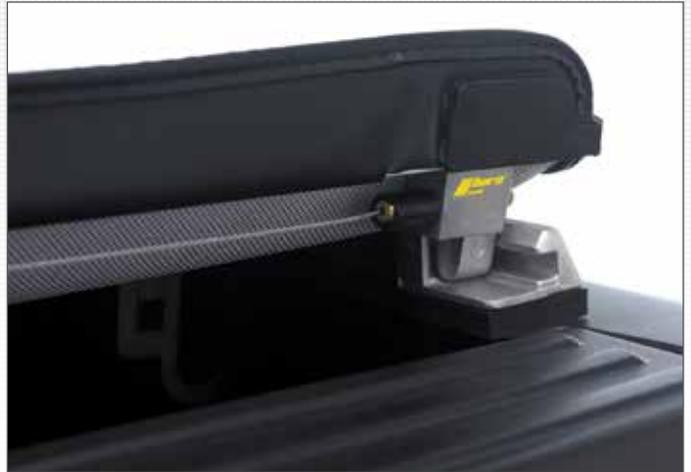
Das „Dual Lock System“ ist einzigartig in diesem Segment. Wenn die Ladeklappe verschlossen ist, kann das Soft Cover nicht geöffnet werden.
