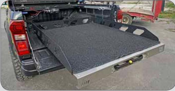
Der PESADA 1512 verfügt über eine Breite von 120cm zwischen den Seitenteilen. Euro Paletten können quer geladen werden, das ist einzigartig. Bei breiteren Ladungen können die Seitenteile leicht entfernt oder verstellt werden.
