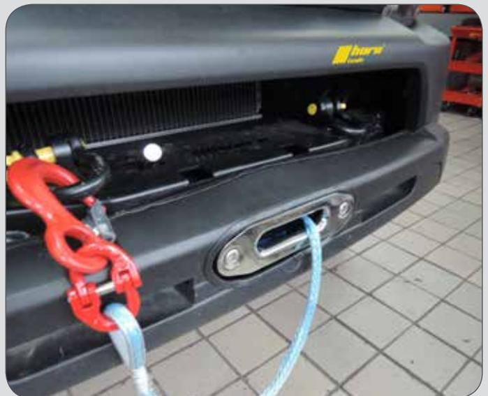
Das voll integrierte Seilwindensystem für den Jimny gibt es in 2 Ausführungen. Inklusiv einer Funkfernbedienung und einem 30m Seil mit 8mm Stärke. Das System ist inklusive TÜV Teilegutachten.
