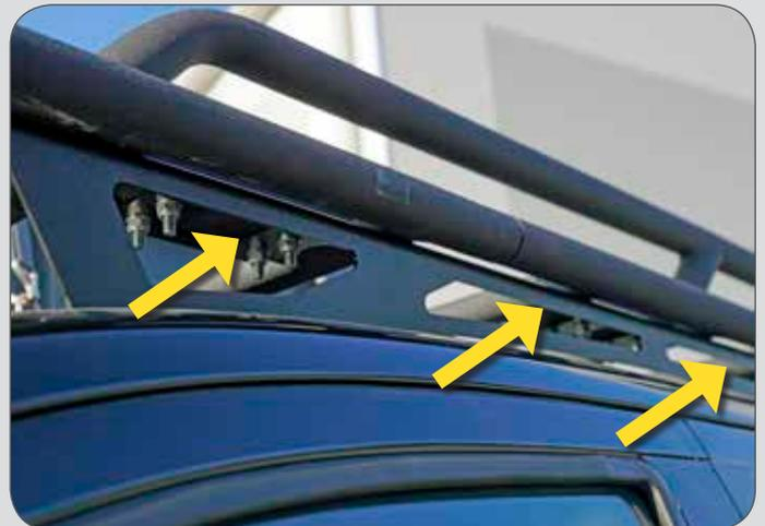
Integrierte Zurrpunkte im Dachträger Fuß
