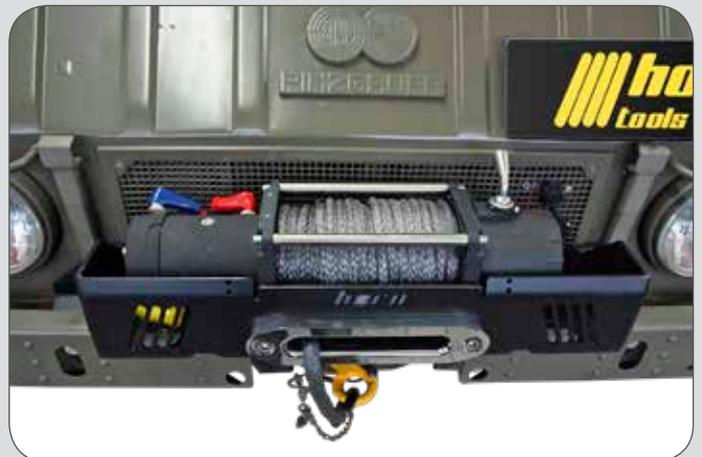
Das Pinzgauer System ist fix verschraubt über die gesamte Länge der Frontstoßstange auf den originalen Punkten. Das gewährleistet eine gleichmäßige Verteilung der Kräfte auf das Fahrzeug. Das System ist in Leichtbauweise gefertigt, da der Pinzgauer vorne schon original kopflastig ist. Der Böschungswinkel wird durch die Seilwinde nicht beeinträchtigt. Die Anbauteile sind verzinkt und gepulvert.
