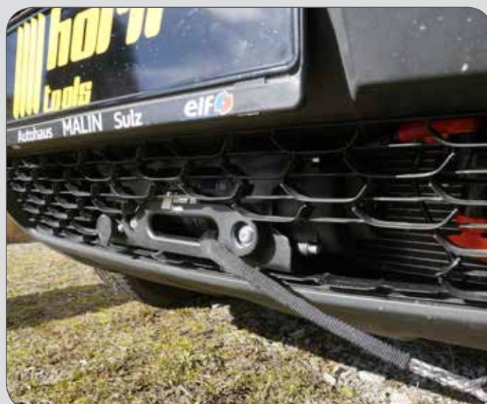
Ein voll integriertes Seilwindensystem für einen der erfolgreichsten Klein-Offroader. Wir haben dem Duster eine 2to starke Winde spendiert und mit einem 6mm starkem 25m Kunststoffseil bestückt.
