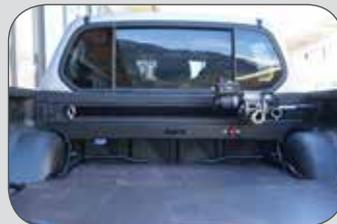
Das Trägersystem arbeitet mit einem Kugelkopf, der flexibel montiert werden kann.
