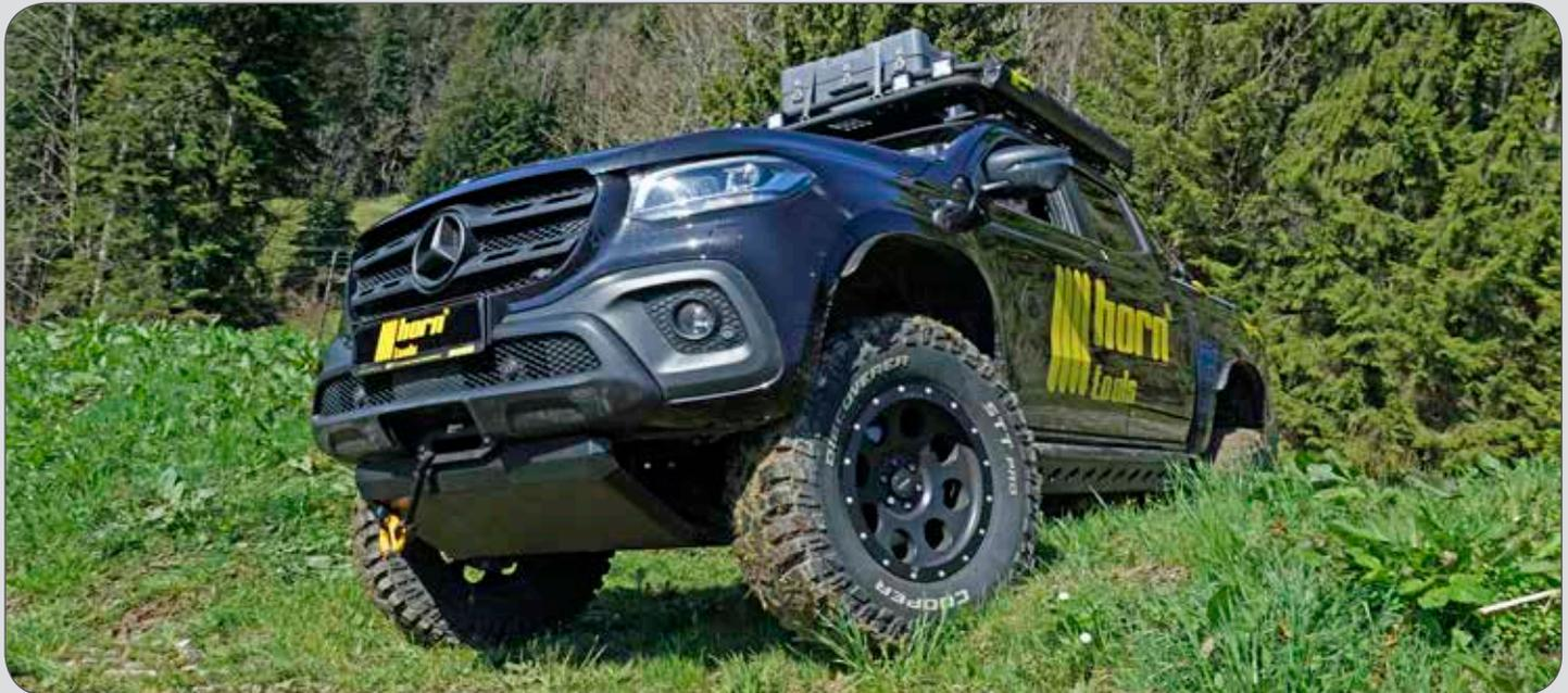
Der Unterfahrschutz von horntools ist aus 4mm Aluminium gefertigt und schützt das Fahrzeug perfekt von vorne bis hinten. Die Bauteile sind schwarz pulverbeschichtet und verfügen über alle Service- und Lüftungskappen, die erforderlich sind.
