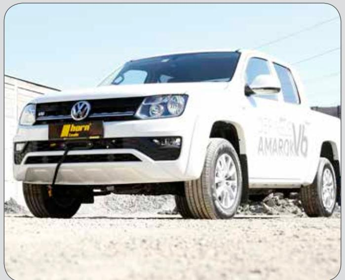
Das Amarok Windensystem kann wahlweise mit Stahl- oder Kunststoffseil geordert werden.
