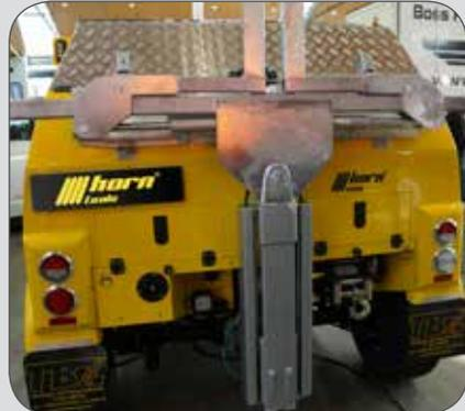
Die Alpha Kompakt wurde für Anwender entwickelt, die wenig Platz haben und bei denen das Gewicht auch eine Rolle spielt. Die wichtigsten Einsatzgebiete sind Anhänger und Abschleppfahrzeuge. Durch die Bauform lässt sich die Seilwinde auch ausgezeichnet als Jagdwinde verwenden.
