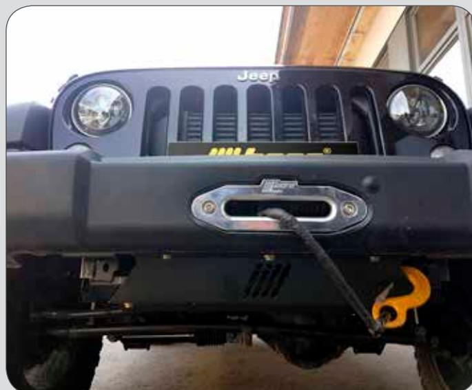
Für das Windensystem haben wir einen kompletten neuen Subrahmen gebaut. Die Seilwinde mit 4,3t Zugkraft ist mit Funkfernbedienung und einem 30m Kunststoffseil ausgestattet.
