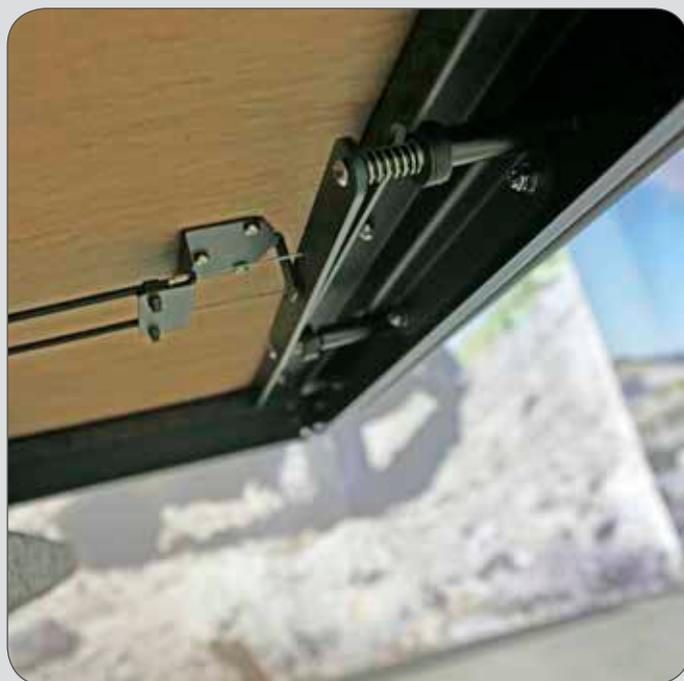
Der Öffnungs-Mechanismus ist spannungsfrei durch ein Doppelfeder-System. Die drei Einrast-Positionen erleichtern das Be- und Entladen.
