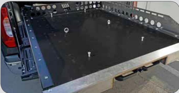
Die sechs M10 Schraubpunkte sind direkt mit dem Rahmen verbunden und ermöglichen eine Fix-Montage von schweren Aggregaten oder Werkzeugen.
