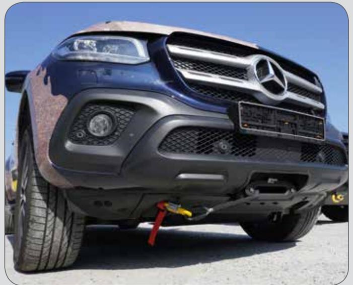
Das Frontwindensystem der X-Klasse zieht mit 4,3to und einer Seilgeschwindigkeit von 15m/min.
