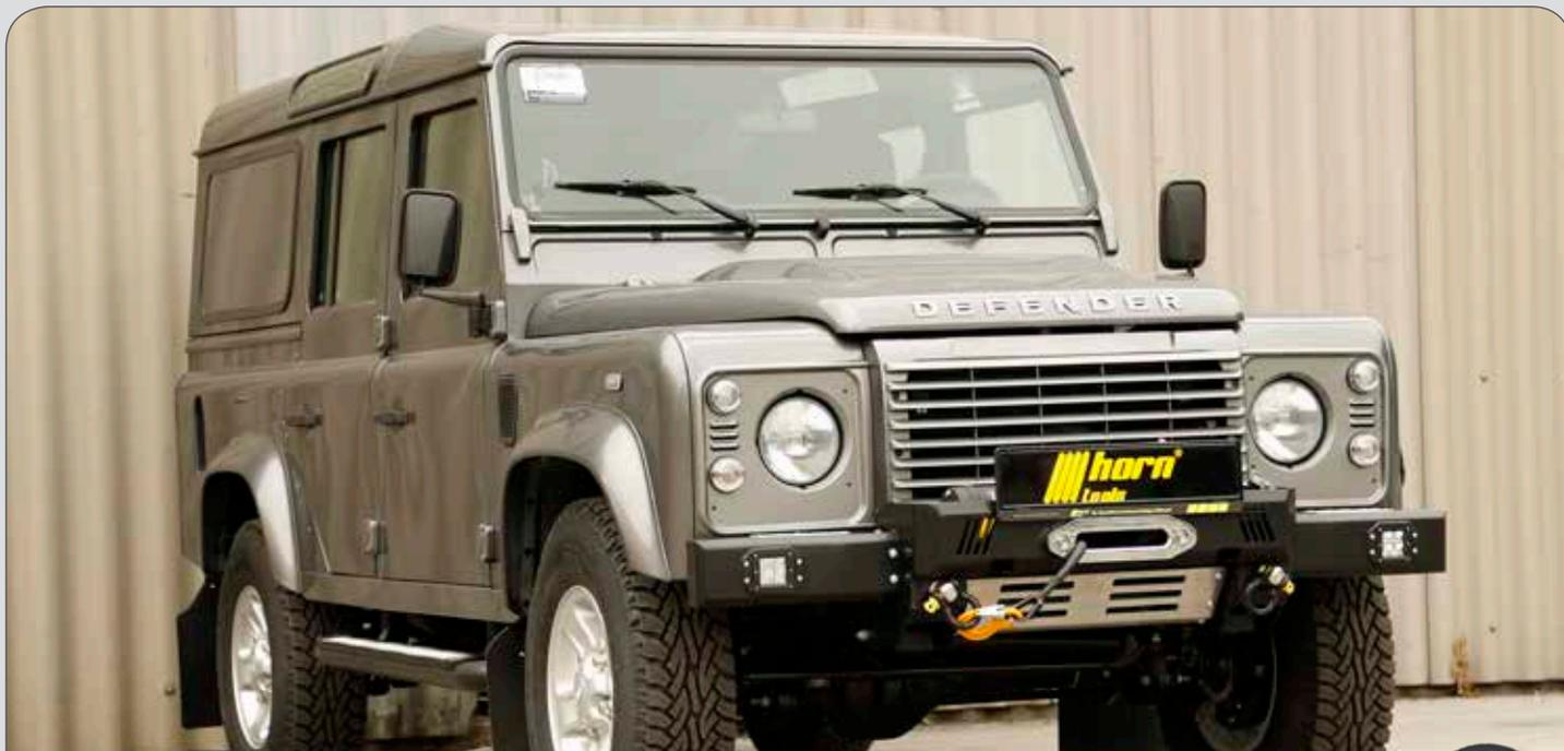
Eine Ära geht zu Ende, aus diesem Anlass haben wir eine völlig neue Stoßstange für die Legende gebaut. Beide Ecken sind schraubbar. Natürlich ist die Stoßstange verzinkt und pulverbeschichtet.
