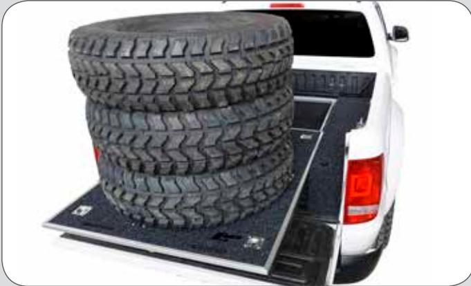
Der Top Auszug ist wie die Schubladen kugelgelagert und mit einem verstärktem Schließmechanismus ausgestattet. Den Top Auszug kann man mit 150kg belasten.
